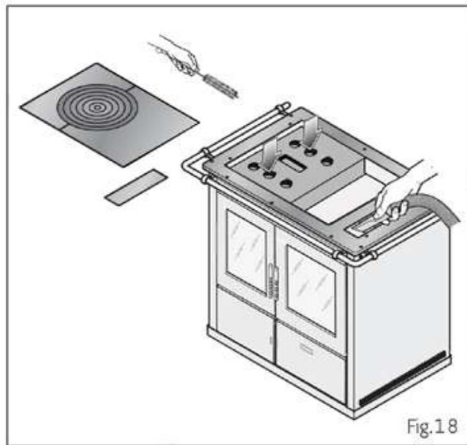
Terminata l'operazione, riposizionare il deflettore nelle apposite sedi poste sulla caldaia. Procedimento inverso (fig. 17).
